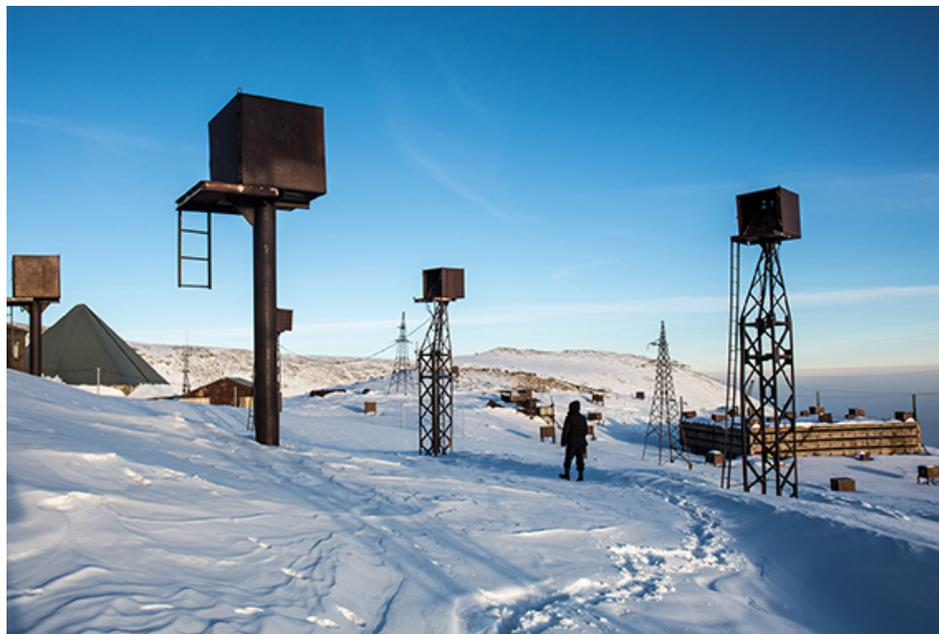
La neige recouvre le sol les deux tiers de l'année avec une température hivernale moyenne: -15 °C. Ces constructions - les «huttes» avec des scintillateurs en plastique, sont issues d'une expérience terminée «MAKET-ANI» il y a 20 ans. Les scintillateurs ont été utilisés pour mesurer la densité d'électrons provenant des gigantesques averses de particules initiées par un proton ou des noyaux de haute énergie dans notre galaxie.
